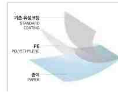
[기존 이형지 구조] STANDARD RELEASE PAPER
